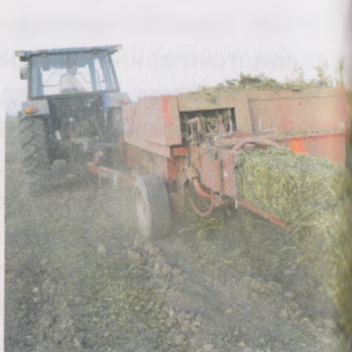
32-33-расмлар. Ерэнгоқ дуккаклари поядан ажратиб олингандан сунг пояларни замонавий МХ-80 тракторига тиркалган CASE-III агрегати ёрдамида пресслаш жараёни
