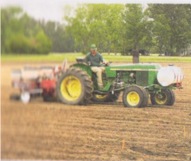
10-расм. Пневматик сеялкада ерэнгоқ экиш жараёни
