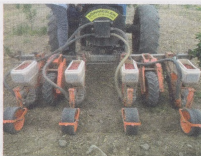
11-расм. Туркияда ишлаб чиқилган сеялка ёрдамида бог қатор ораларига ерэнгоқ экиш жараёни
