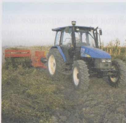
32-33-расмлар. Ерэнгоқ дуккаклари поядан ажратиб олингандан сунг пояларни замонавий МХ-80 тракторига тиркалган CASE-III агрегати ёрдамида пресслаш жараёни
