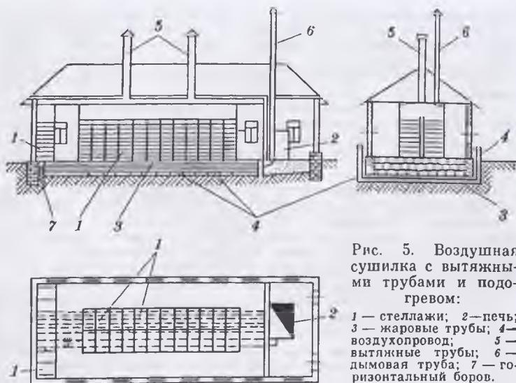
Рис. 5. Воздушная сушилка с вытяжными трубами и подогревом:
