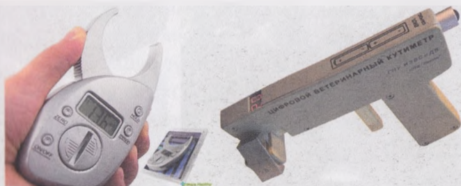
38-расм. Тери қалинлигини ўлчаш учун оддий ва замонавий кутиметрлар
