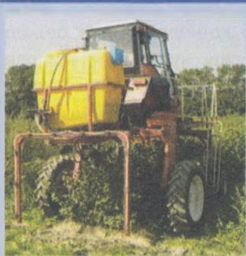
Опрыскиватель малообъемный универсальный ОМУ-600
