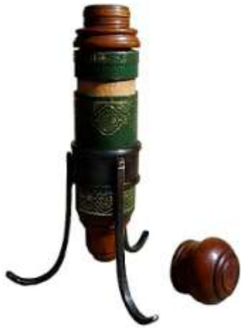
Рисунок 63 – Микроскоп, разработанный Галилео Галилеем (в собранном состоянии)
