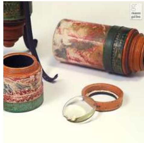
Рисунок 64 – Устройство микроскопа, разработанного Галилео Галилеем
