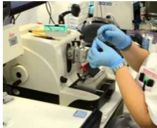
Рисунок 96 – Работа лаборанта на ротационном микротоме
