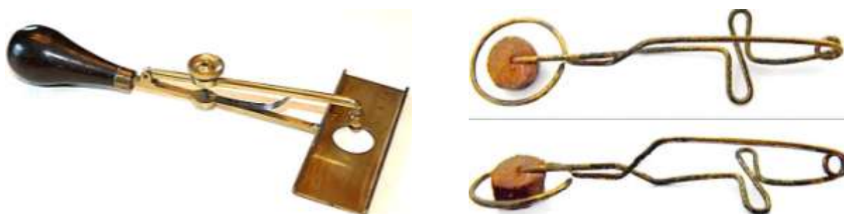
Рисунок 152 – Старинные щипцы для приготовления гистологических препаратов: браниши щипцов прижимали покровное стекло к предметному, удерживая их от смещения до тех пор, пока канадский бальзам не высохнет (середина – конец XIX века, Британская империя)
