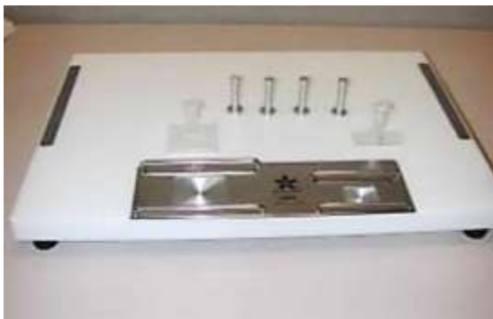
Рисунок 111 – Доска для вырезки операционного материала в патолого-анатомическом отделении: позволяет получать серию одинаковых таневых пластинок заданной толщины 1,5–2 мм
