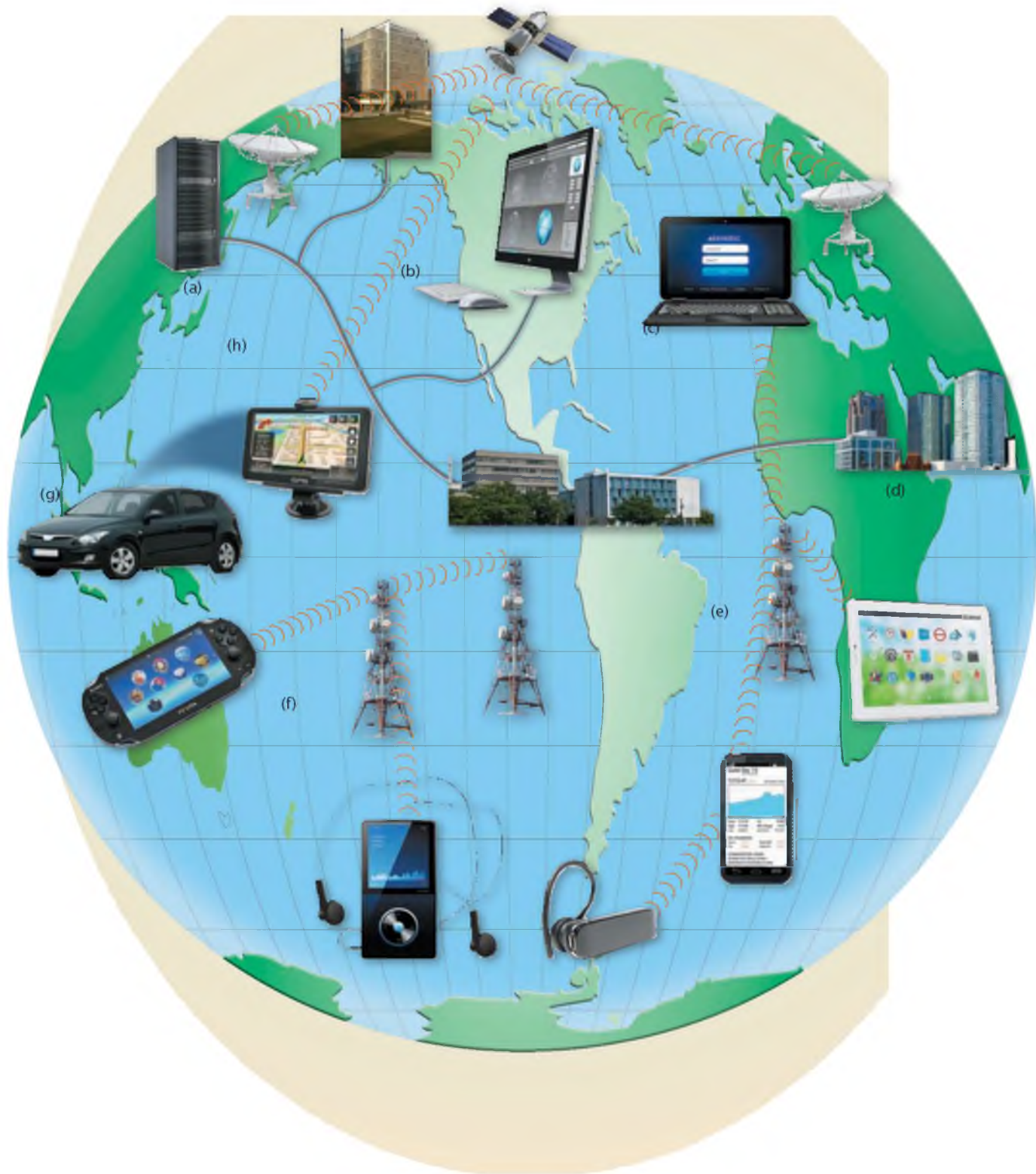
10-1 rasm . Muloqot yo'llarini osonlashtirilgan namunasi. Ba'zi (a) serverlar, (b) kompyuterlar, (c) noutbuklar, (d) tabletlar, (e) uyali aloqa vositalari va quloqjinlar, (f) media playerlar, (g) o'yin qurilmalari va GPS jo'natuvchi va qabul qiluvchi qurilma sifatida xizmat qiladi. Omaviy axborot vositalari uyali aloqa, quvvat yo'llari, televizor kabeli va ko'plab boshqa yer osti yo'llari, mikroto'lqinli stansiyalar va sun'iy yo'ldshlarni o'z ichiga oladis.
