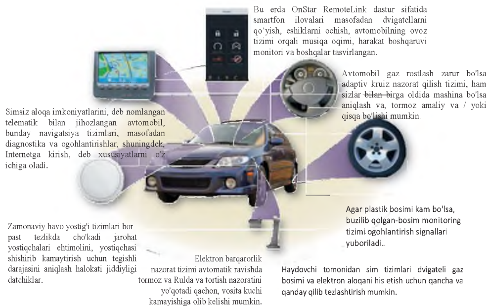
3-24 rasm. Ba'zi o'rnatilgan kompyuterlar zamonaviy transport vositalari sizning xavfsizlik, xavfsizlik va ish faoliyatini yaxshilash uchun mo'ljallangan.
