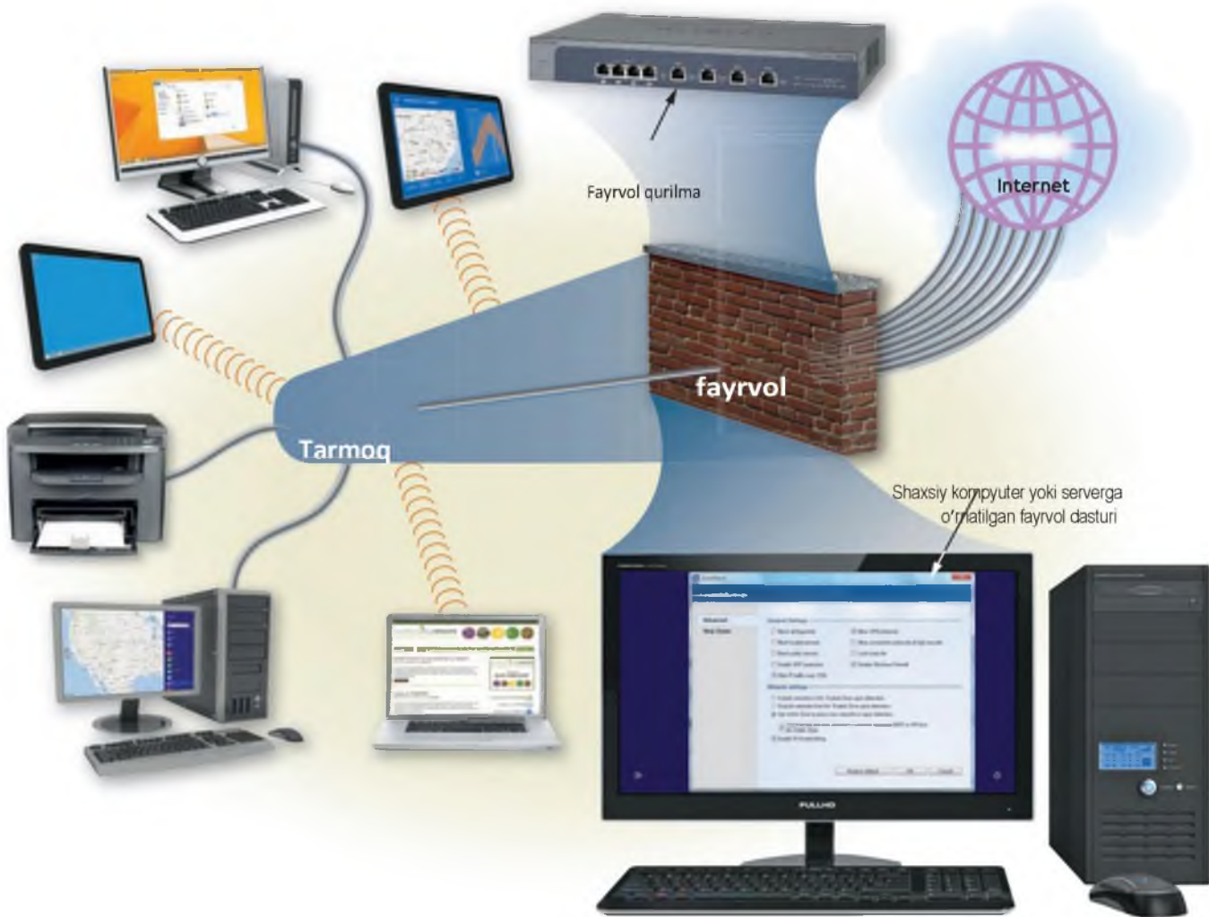
5-4 rasm. Fayrvol qurilma yoki dasturiy ta'minot bo'lishi mumkin bolib, uy yoki firma tarmog'li resurslarini shilqim foydalanuvchilardan yoki boshqa tarmoqlardan xususan internetdan himoya qiladi.
