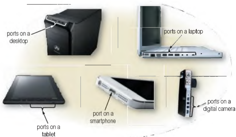
3-25 Rasm: Ko'pgina kompyuter va mobil qurilmalar portlarga egadir, pereferik qurilmalar uchun kompyuter va qurilmani ulashingiz mumkin.
