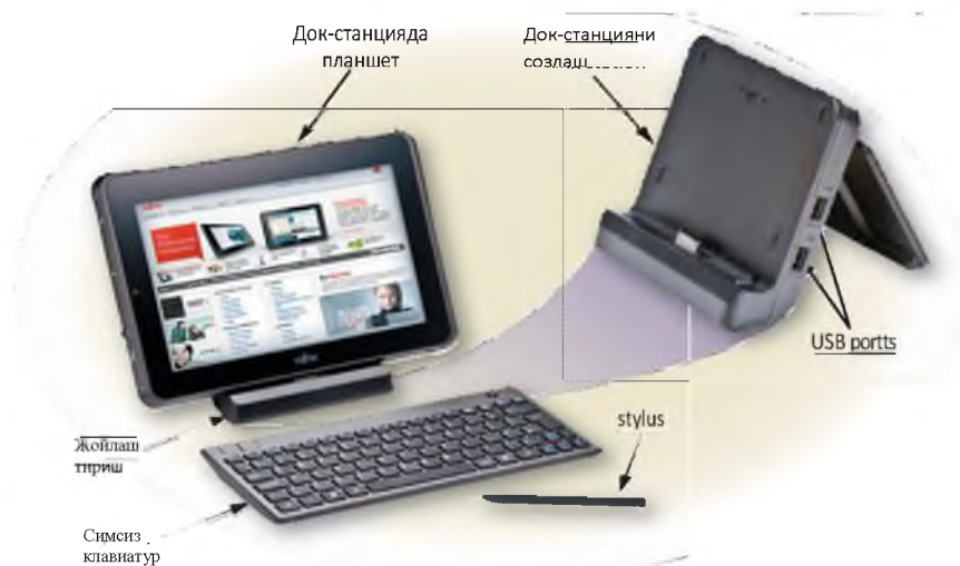
3-26 Rasm: Dok-stansiyalar odatda perefirik qurilmalar bilan aloqa o'rnatishni ta'minlaydi.
