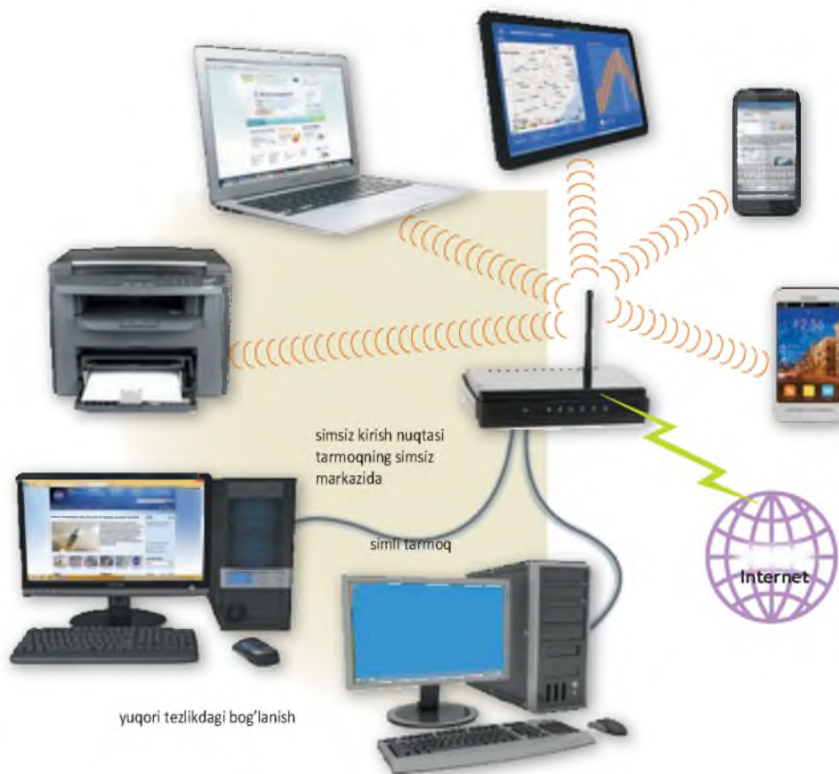
Rasm 10-4 WLAN dagi kompyuterlar va mobil qurilmalar simli LAN bilan simsiz kirish nuqtasi orqali LAN ning kompyuter qismlari, kompyuter dasturlari, internet bog'lanish va boshqalari bilan aloqada bo'lishi mumkin.
