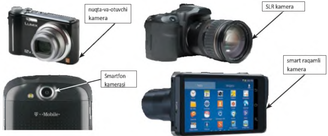
3-16-rasm. SLR raqamli kameralar linzalar va qo'shimchalarga ega qurilmalar. Ko'pgina smartfonlar ichki o'rnatilgan raqamli kameralarga ega.
