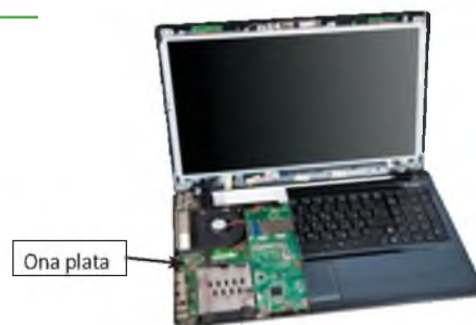
3-2-rasm. Ноутбукудаги она платани кisman кўриниши тасвирланган.
