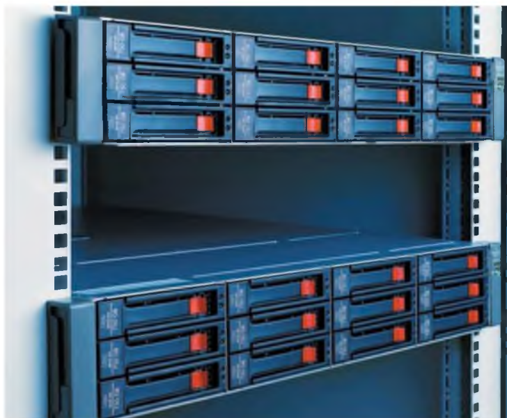
8-17-rasm. Bu erda RAID shassi va ko'p kompleks qattiq disklar keltirilgan.
