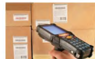
3-6-rasm. Bu portativ kompyuter ombor xodimlariga zaxiralarni tekshirish va inventarizatsiya o'tkazish imkonini beruvchi engil kompyuterdir.
