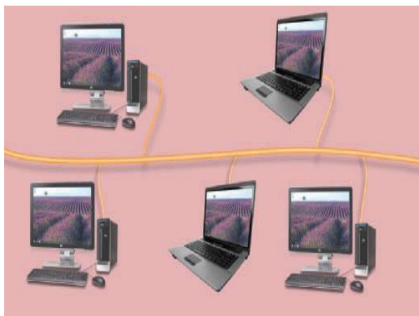
222-rasm. Shina topologiyasida kompyuterlarni ulanishi
