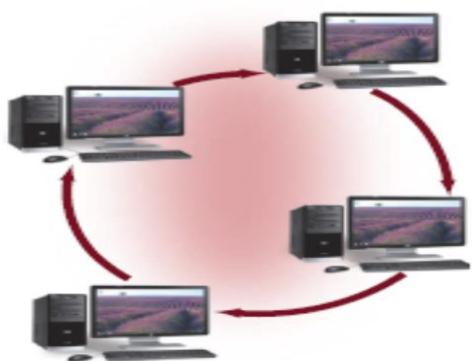
221-rasm. Xalqa topologiyasida kompyuterlarni ulanishi
