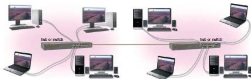
224-rasm. Konsentrator yoki kommutator orqali tarmoqqa ulanish
