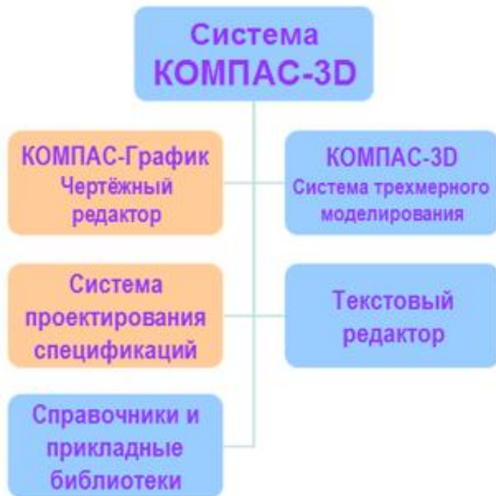
Рисунок 4.1 – Структура системы КОМПАС-3D
