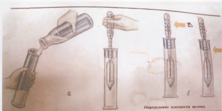
33-расм. Сутнинг зичлигини аниқлаш тартиби. 1-улчов цилиндрига сутни қуйиш; 2-3 цилиндирдаги сутга ариометрни ботириш; 4-сутдаги ҳароратни аниқлаш; 5-сутнинг зичлигини аниқлаш.
