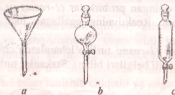
4-rasm. Voronkalar: a-kimyoviy; b-tomizgich; c-ajratkich
