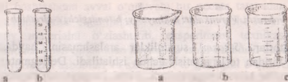
1-rasm. Probirkalar: a-oddiy; b-kalibrovka qilingan. Kimyoviy stakanlar: a-burunchali; b-burunchasiz; c - kalibrovka qilingan.
