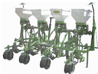
26- rasm. Chiglit ekish seyalkasining umumiy ko'rinishi.
