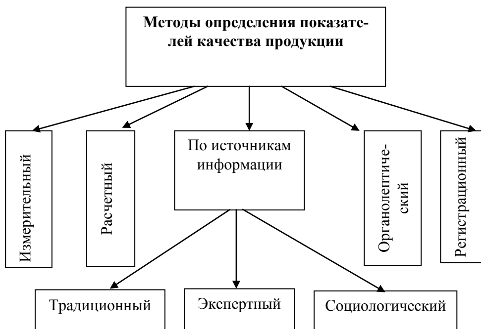
Рис. 7. 2. Классификация методов определения показателей качества продукции
