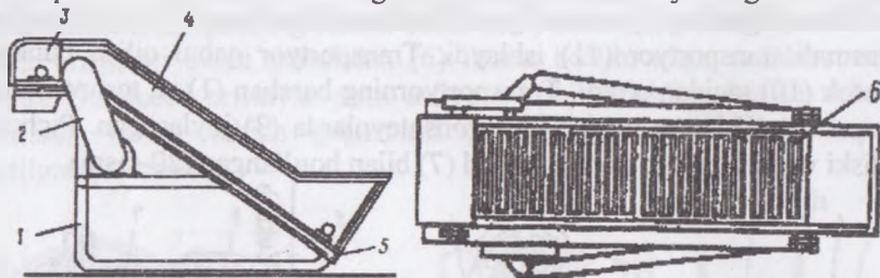
21-rasm. Meva va sabzavotlarni doira shaklida kesuvchi mashina: 1 – stanina; 2 – uzatma; 3 – kesuvchi moslama; 4 – kojux; 5 – karkas; 6 – lotokli transportyor.
