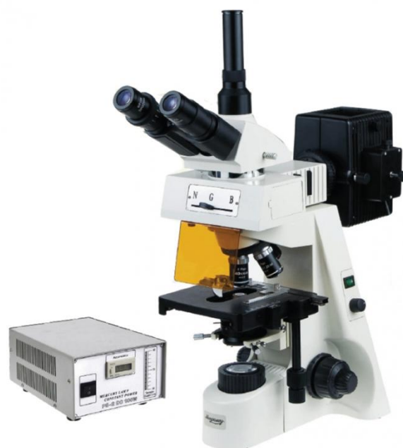
Люминесцент микроскоп Микромед 3 ЛЮМ
