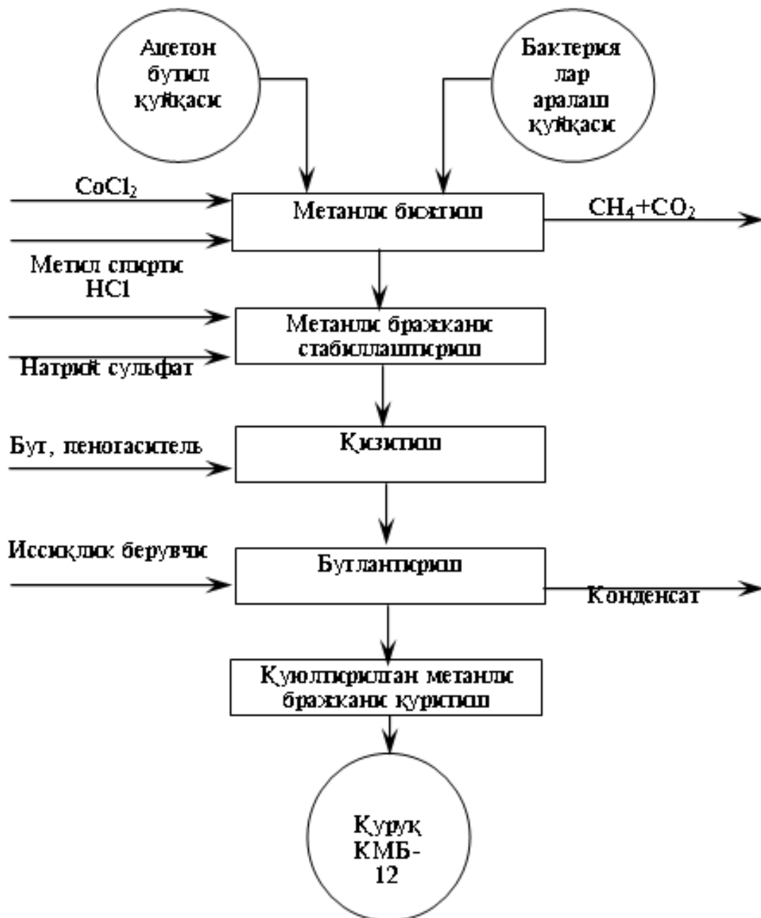
7.3.-чизма. Озуқа концентрати В 12 - витаминини ишлаб чиқаришнинг технологик чизмаси
