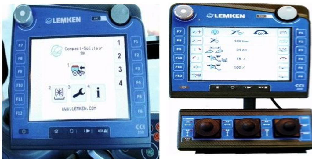
4.4-расм. Белгилар ва пиктограмма қурилмаси (а) ҳамда плугни бошқариш учун джойстли CCI/ISOBUS терминали (б)
