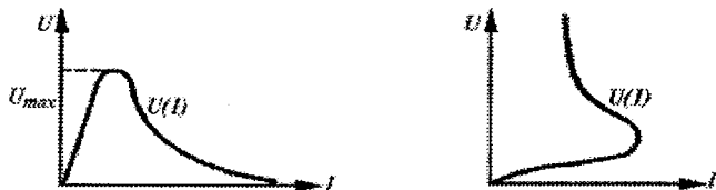
4.13 - rasm. Termorezistor (a) va pozistor (b) larning volt-ampere xarakteristikalari.
