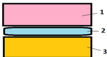
1.4-rasm. Suyuqlikli tinchlantirgich: 1-aylanuvchi qism; 2-suyuqlikli tinchlantirgich; 3-qo'zg'almas qism.
