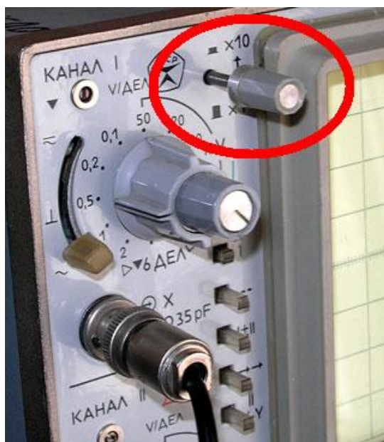
8.15-rasm. Vertikal boʻylab oʻlchovning koʻpaytmasi dastakning "x1" holatiga(pozitsiyasiga) oʻrnatilgan.
