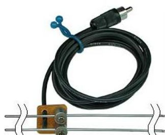
8.29-rasm. Tuproqning namligini(uning qarshiligi orqali) o‘zgaruvchan tokda o‘lchash uskunasi tashqi ko‘rinishi.
