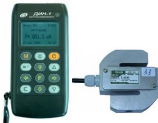
8.39-rasm. DIN-1 rusumli elektronli dinamometrlar.
