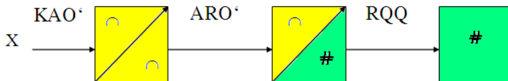
6.6-rasm. Raqamli o‘lchash asbobining funksional chizmasi.
