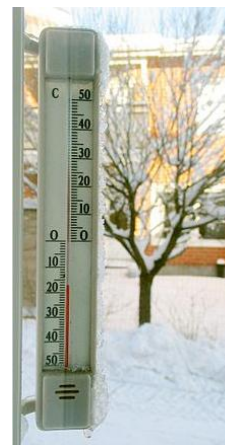
8.35-rasm. Ko'chadagi harorat oddiy Selsiy shkalasiga ega termometr bilan o'lchanganida -17^{\circ}\text{C} ni ko'rsatmoqda.
