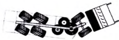
1.14-rasm. Kompyuterlashtirilgan rul boshqarmasi ega Ropa firmasining gidrostatik uzatkichli o'ziyurar mashinasi.
