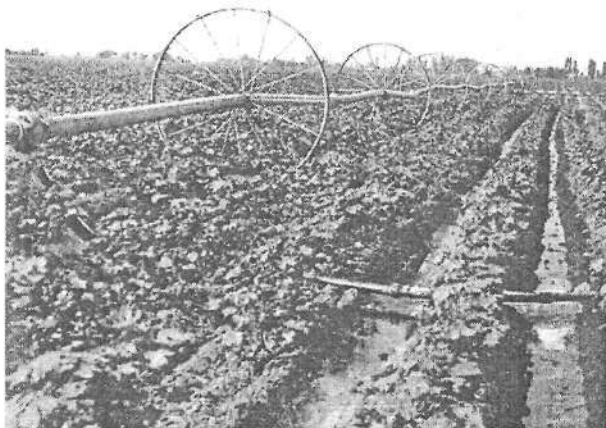
31-rasm. ДКШ-64 «Voljanka» yomg'irlatib sug'orish mashinasi.
