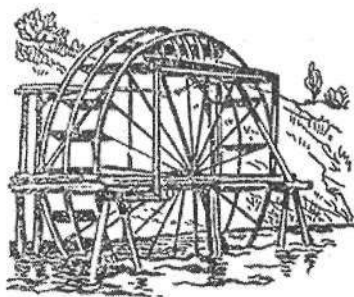
2-rasm. Chig'ir: 1 – sizot suvini ko'tarib beruvchi va 2 – daryodan suvni ko'tarib beruvchi charxpalak.
