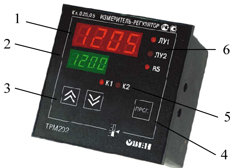
Рисунок 6 – Измеритель-регулятор температуры ТРМ202. 1 – экран; 2 и 3 – кнопки задания уставки; 4 – кнопка программирования и задания режимов работы прибора.
