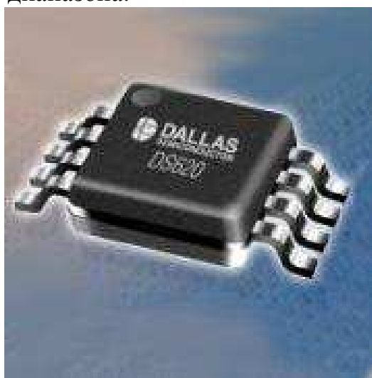
Рисунок 1 - Кремниевые датчики температуры
