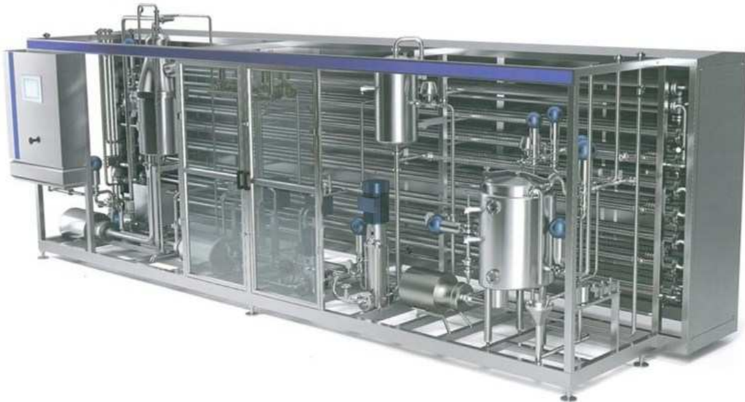
Рисунок 8 - Автоматизированная стерилизационно-охладительная установка для высокотемпературной обработки УВТ (УНТ)
