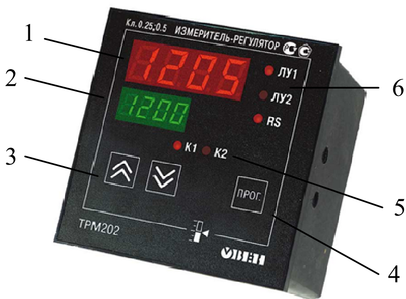
Рисунок 12 - Измеритель-регулятор температуры ТРМ202.
