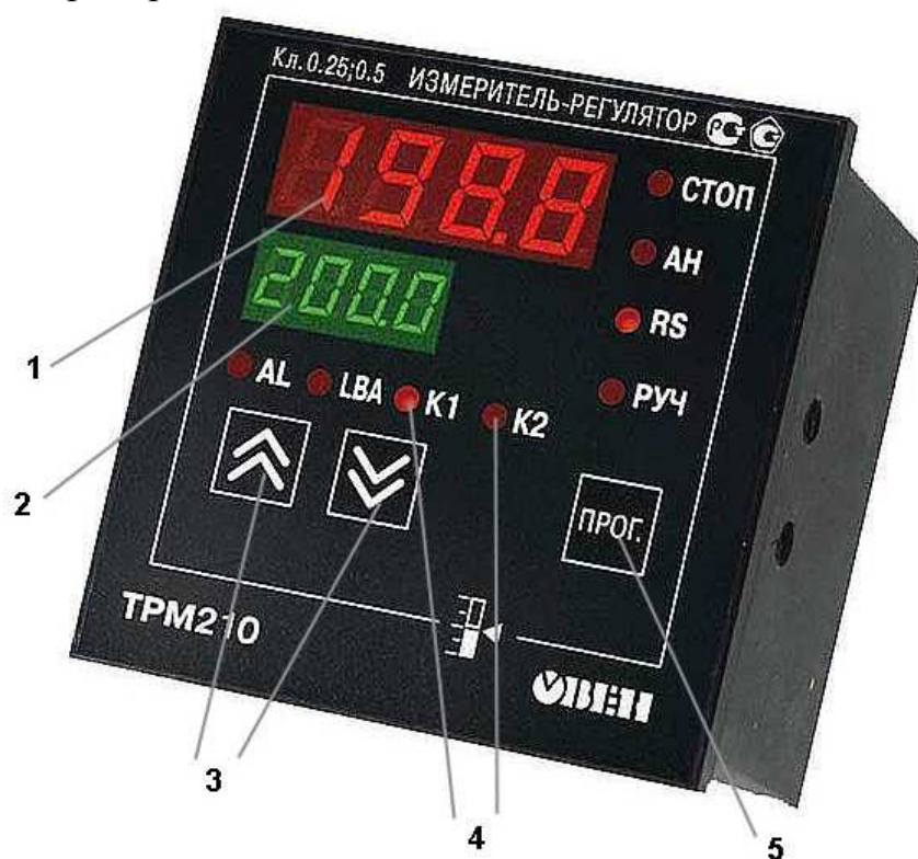
Рисунок 8 - Измеритель-регулятор ОВЕН TPM210.
