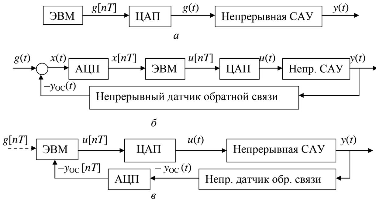
Рис. 2.1.3. Одноконтурные САУ с микроЭВМ
