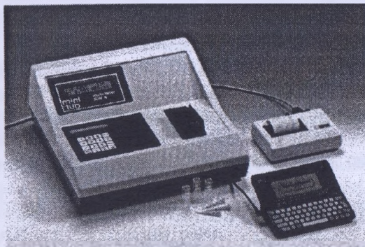
27-rasm. Spermadagi spermiylar konzentratsiyasini aniqlash asbobi.
