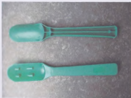
Рисунок 352. Пластмассовый разовый шпатель-пробоотборник - Bio-Rad, IDEXX, Prionix ( https://works.doklad.ru/view/1Mo9C-TEN3U/all.html )
