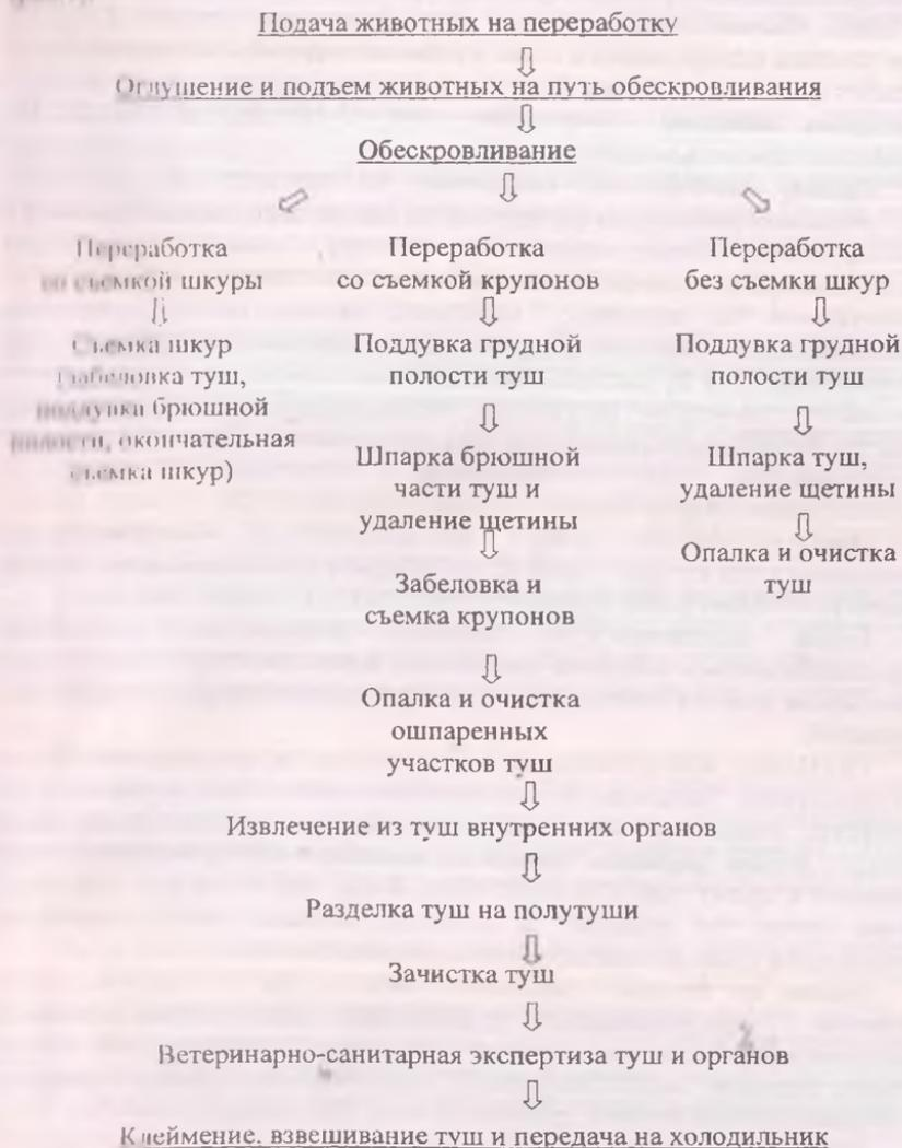
Рисунок 7 – Схема переработки свиней
