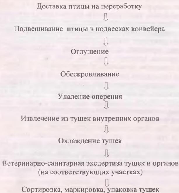
*Доставляют* птицу на птицеперерабатывающее предприятие на автомашинках в контейнерах, которые подают к месту навешивания на конвейер.
