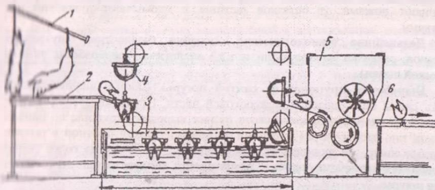
Рисунок 10 – Схема переработки свиней со съемкой крупона
