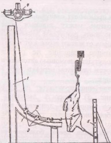
Рисунок 4 – Механическая съемка шкур с туш крупного рогатого скота
