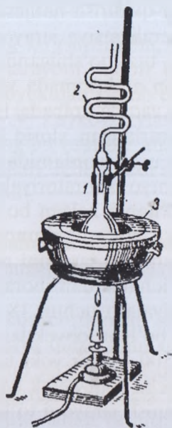
5.3-rasm. Frezenius va Babo usulida mineralizatsuya qilish qurilmasi
