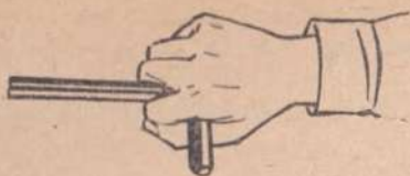
Рис. 1.1. Правильный захват шнура при запуске пускового двигателя.
