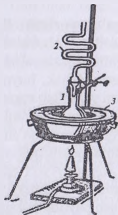
6.1-rasm. Frezenius va Babo usulida mineralizatsiya qilish qurilmasi:
