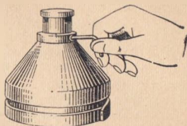
Рис. 23. Регулирование жирности сливок при помощи сливочного винта.
