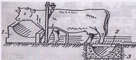
7-rasm. Signrxonada yoriq polning tuzilishi. 1. Oxur. 2. Polning qiyaligi 3. Go'ng arig'i.
