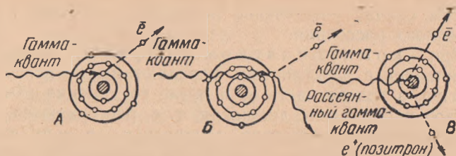
Рис. 9. Виды взаимодействия \gamma -излучения с веществом: А — фотоэлектрическое поглощение; Б — комптоновский эффект; В — образование пар.
