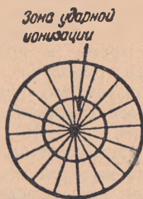
Рис. 14. Поперечное сечение счетной трубки с изображением расположения силовых линий.
