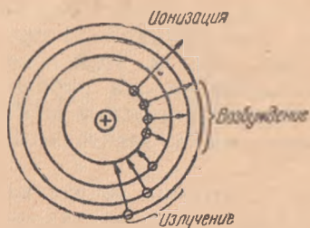
Рис. 2. Схема электронных переходов в атоме.
