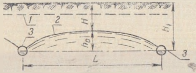
Рис. 60. Схема понижения уровня грунтовых вод горизонтальным дренажем:
