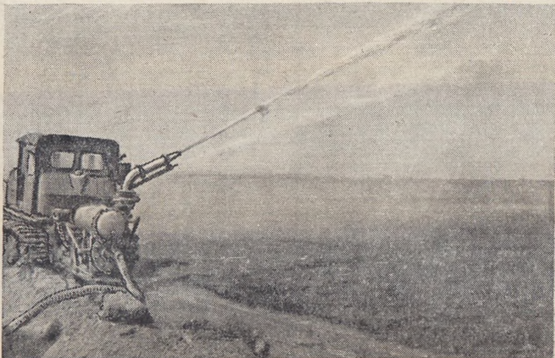
Рис. 15. Дождевальная дальнеструйная машина ДДН-45 в работе.
