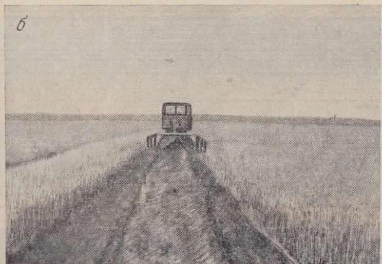
Рис. 25. Нарезка (а) и заравнивание (б) временного оросителя канавокопателем КПУ-2000А.
