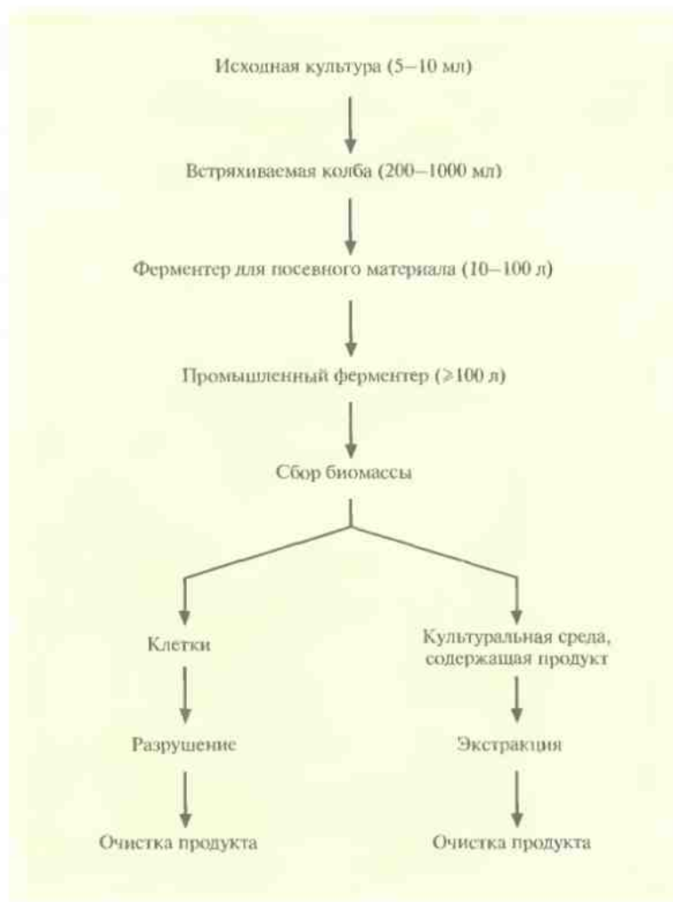
Рис. 16.1. Обобщенная схема процесса промышленной ферментации. Выделяемый продукт находится либо в клетках, либо в культуральной среде, но не в обеих фракциях одновременно, так что дальнейшие манипуляции проводят с одной из этих фракций.
