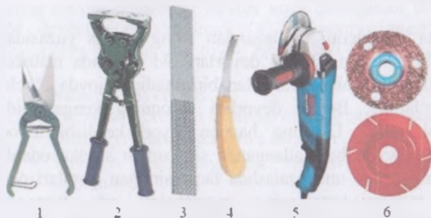
14–rasm. Taqachilik asboblari: 1–tuyoq qaychisi; 2–tuyoq omburi; 3–rashpil (katta egov); 4–tuyoq pichog‘i; 5–kesish va sayqallash uchun elektr asbob; 6–sayqallash diskleri.
