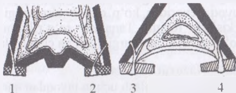
28-rasm. Taqa mixlarining noto'g'ri qoqilishi: 1-mixning to'g'ri joylashishi; 2-mixning bevosita sanchilishi «zakovka»; 3-ikkiga ayrilgan mixning sanchilishi; 4-mixning bilvosita sanchilishi.
