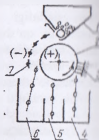
1 – bunker; 2 – elektrik buratish; 3 – cho'tka; 4,5,6 – nov; 7 – qarama-qarshi elektrod
