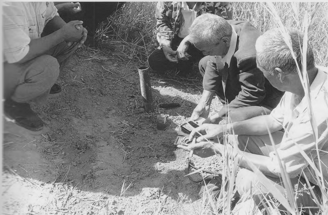
6-расм. Фермерларга сув ва тупроқ шўрланишини электр ўтказувчанликни ўлчовчи мослама ёрдамида тез ўлчайдиган анализатор намойиш этилмоқда
