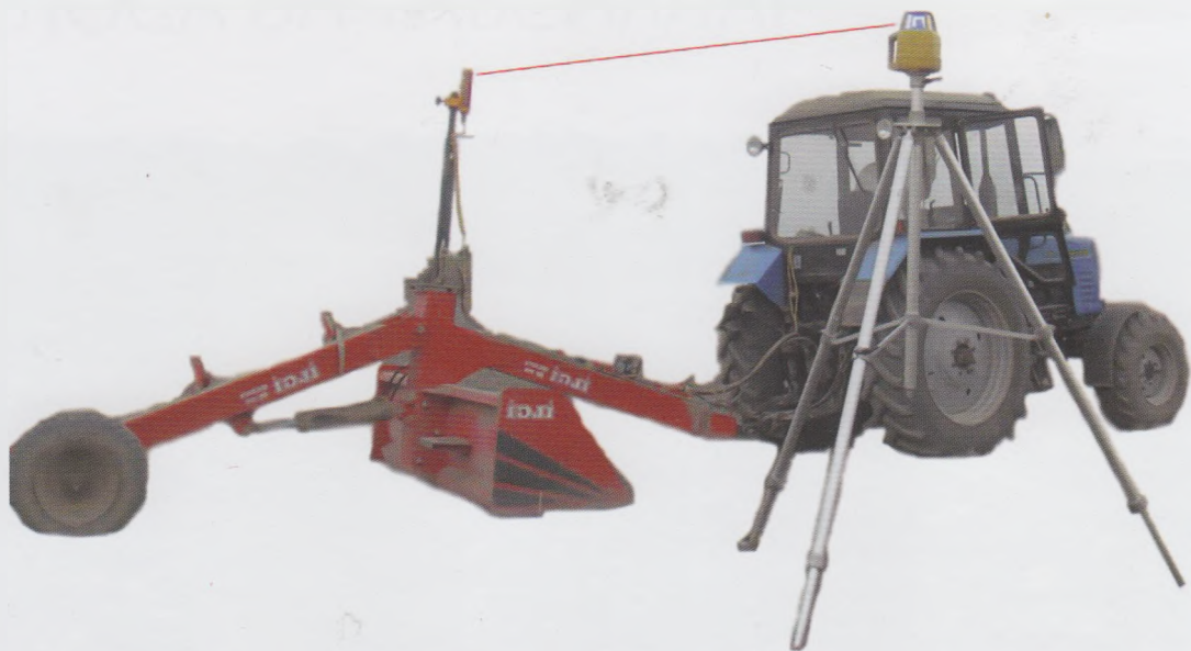
17-расм. Ер текисловчи тракторга ўрнатилган айланувчан лазер ва қабул қилувчи
