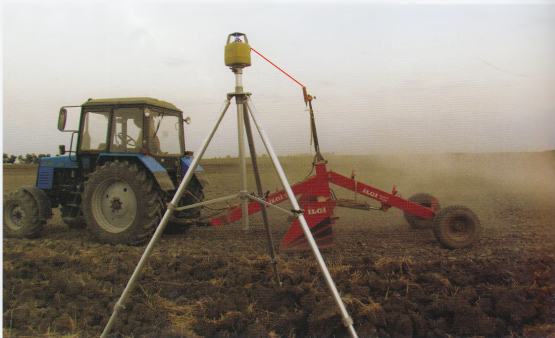
26-расм. Ер текисловчи тракторга ўрнатилган қабул қилувчи ва айланувчан лазер
