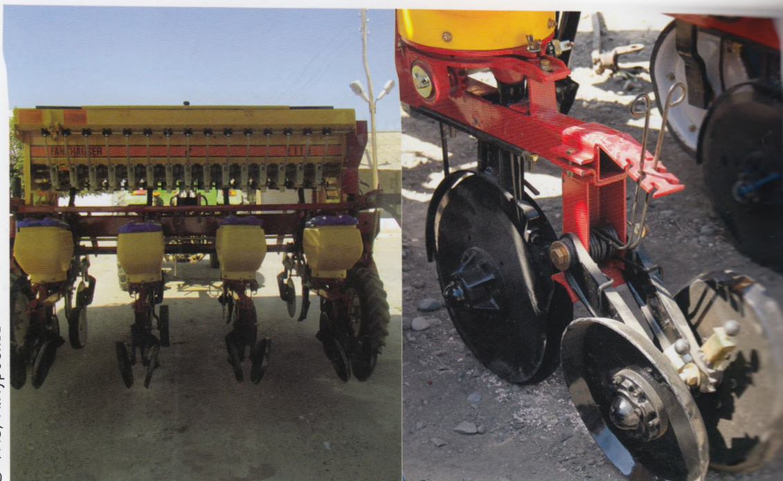
21-расм. Шудгор қилинмаган ерлар учун мўлжалланган тўрт қаторли сеялка, дискли қатор очувчилари билан (чапда), ўлчаб экувчи ғилдирак ва икки дискли қатор ёпувчи ғилдираклар (ўнгда)
