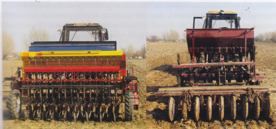
20-расм. Маҳаллий СЗС-2.1 анғизга экиш сеялкаси (чапда) ва шудгор қилинмаган ерга экишга мўлжалланган FANKHAUSER 2115 сеялкаси (ўнгда)
