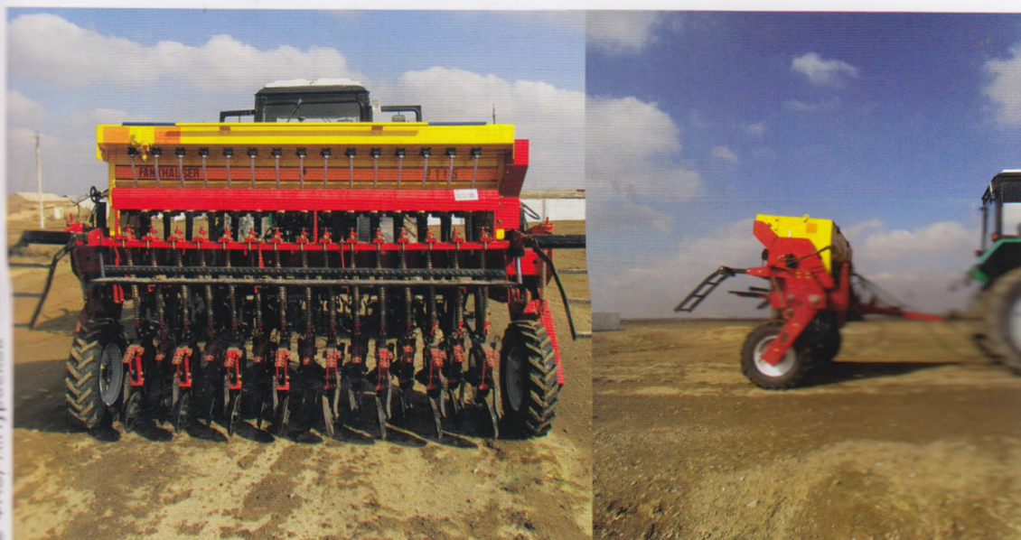
22-расм. Дала экинларини шудгор қилинмаган тупроққа экиш учун мўлжалланган сеяланинг орқа ва ўнг томондан кўриниши
