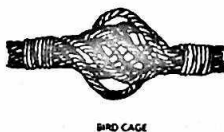
22-rasm. Po'lat arqonlar nuqsonlari
