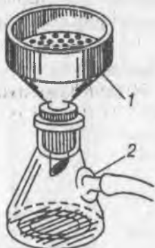
10-Rasm. Filtrlash asbobi (vakuumda): 1) Byuxner voronkasi, 2) Bunzen kolbasi;
