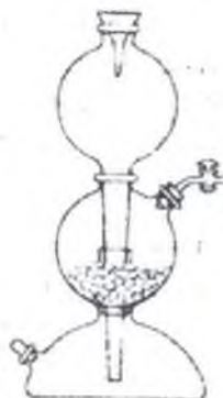
57-rasm. Kipp apparati. 1-o'rtasi ingichka idish; 2-shar holdagi voronka; 3-jo'mrakli gaz chiqadigan naycha; 4-qavta ishlangan suyuqlikni solish uchun idish
