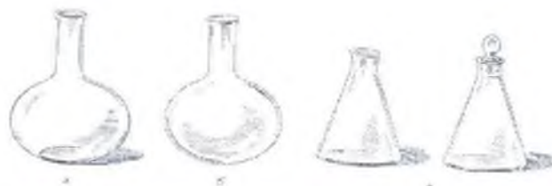
4-rasm. Kolbalar: a-tagi yassi; b-tagi dumaloq; v-konussimon
