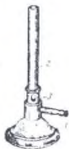
34-rasm. Muftali gaz gorelkasi: 1-asos; 2-trubka; 3-havo oqimini boshqaruvchi mufta.
