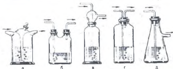
61-rasm. Yuvuchi sklyankalar: a-Tishenko sklyankalari; b-ikki bo'yinli sklyanka; v, g, d-yuvgichlar.
