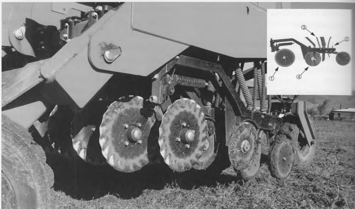
22-расм. Great Plains 1007NT шудгор қилмай экиш сеялкаси: 1 – қирқувчи диск (кольтер), 2 – уруғни экиш чуқурлигини назорат қилиш механизми, 3 – дискни тозалаш механизми, 4 – дискли сошник.
