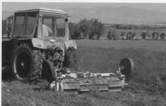
14-расм. Қоплама экинларни бостириб янчиш учун барабанли қурилма.
