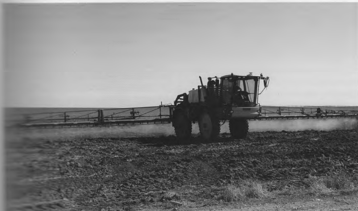
15-расм. Гербицидларни қўллаш учун қанотли пуркагич.
