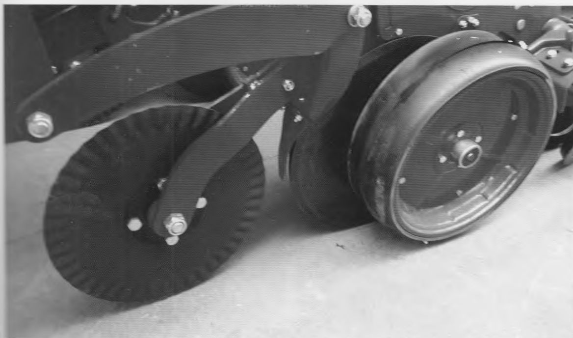
30-расм. Ўсимлик қолдиқларини қирқиш диски (кольтер).
