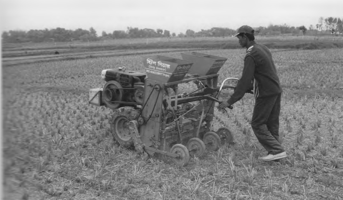
20-расм. Мотоблокка ўрнатилган шудгор қилмай экиш сеялкаси.
