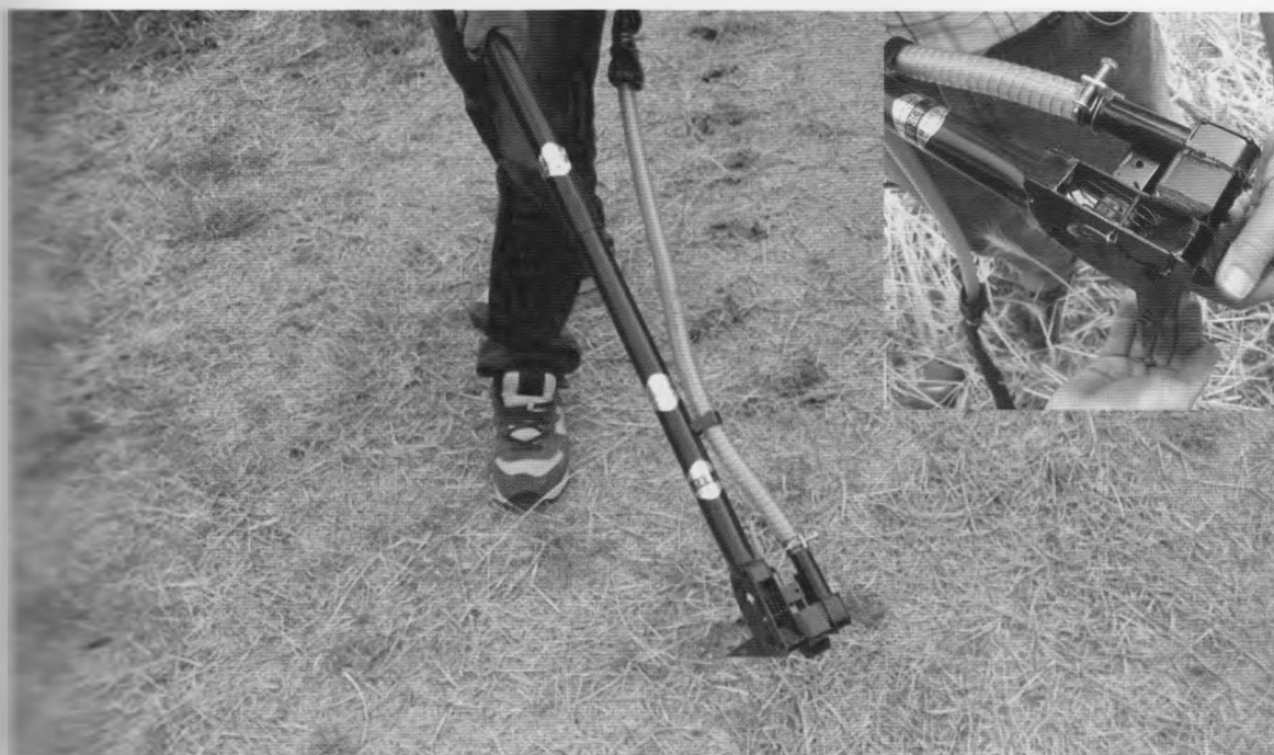
18-расм. Шудгор қилмасдан экиш учун мотигали сеялка.
