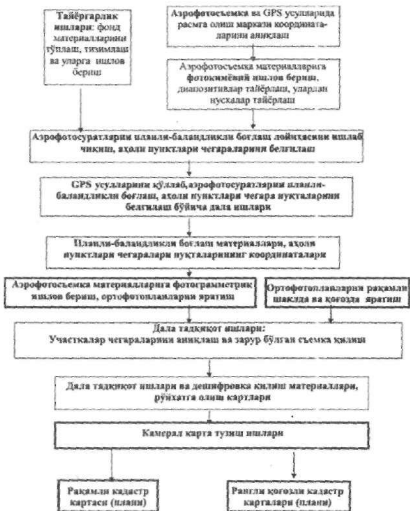
4.1-расм. Ортофотоплавларни далада дешифровка қилиш йўли билан кадастр план ва карталарини яратиш технологик чизмаси
