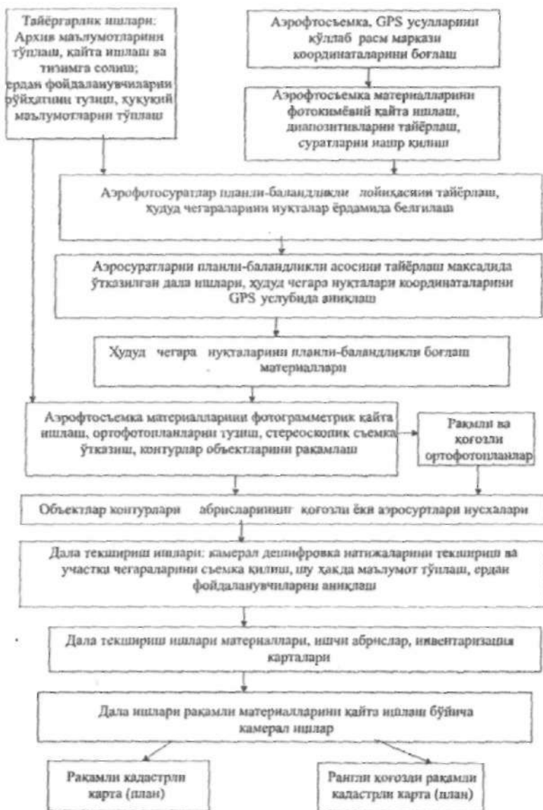
4.3-расм. Фотограмметрик тизимда дастлабки камерал дешифровка қилиш йўли билан кадастр план ва карталарини яратиш технологик чизмаси
