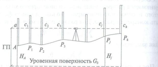
Рис. 10.2. Горизонт прибора
