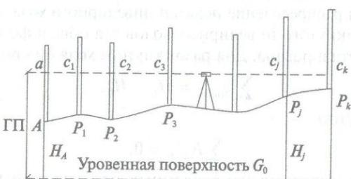
Рис. 10.2. Горизонт прибора
