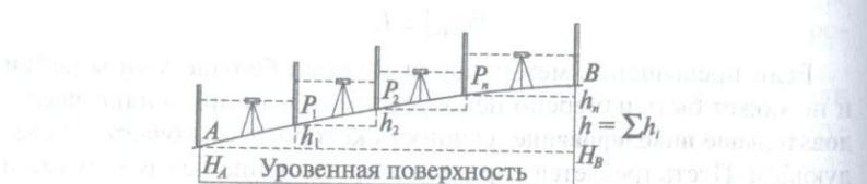
Рис. 7.9. Последовательное нивелирование
