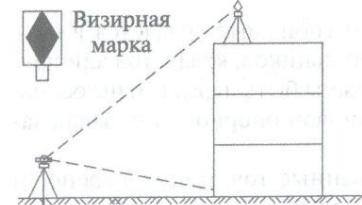
Рис. 15.6. Наклонное проектирование
