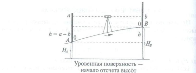
Рис. 7.1. Принцип геометрического нивелирования
