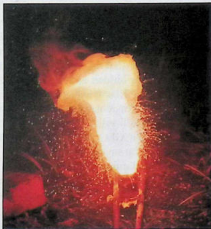
Temir(III) oksididan foydalangan holda termit reaksiyasi. Chaqmoqlar tashqariga uchayotgan qoldiqlar – eritilgan temir globulalari bo'lib, ular ortidan tutun izlari qoladi.
