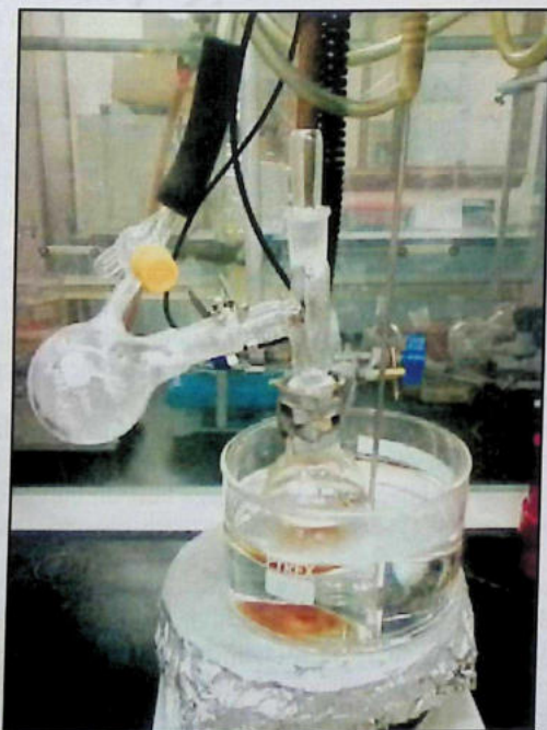
Dimetilsulfoksid odatda 18^{\circ}\text{C} da qaynaydi. Vakuum ostida esa u faqat 70^{\circ}\text{C} da qabul qiluvchiga distillatsiya qilinadi.
