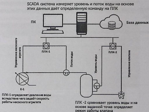
Рисунок 1.4. Концепция управления в SCADA системе.
