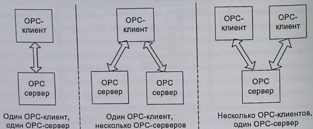
Рисунок 3.4. Клиент-серверная архитектура ОПС
