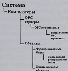
Рисунок 3.5. Системная архитектура OPC
