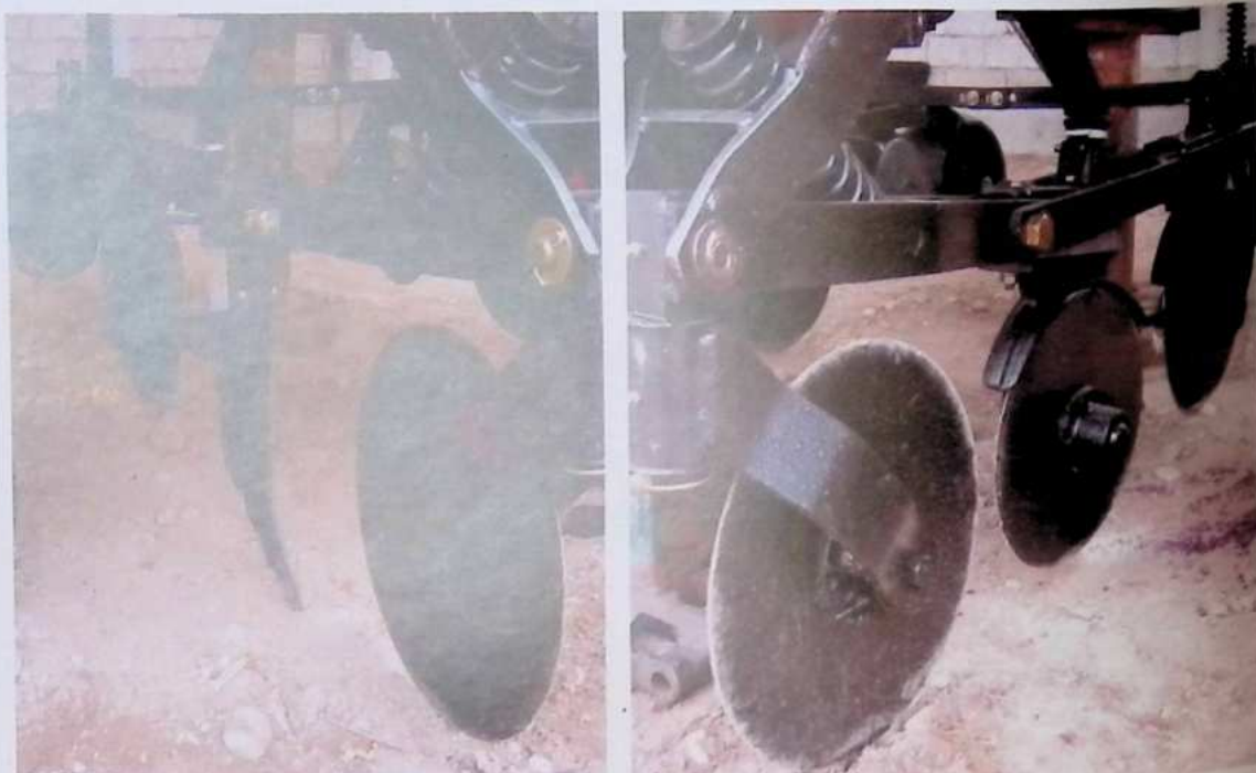
32-расм. Чизелли (чапда) ва қўшалок диски (ўнгда) ўғит солиш қурилмаси.
