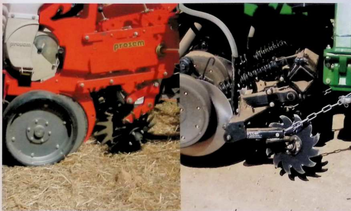
24-расм. Қирқувчи дискларнинг намуналари.
