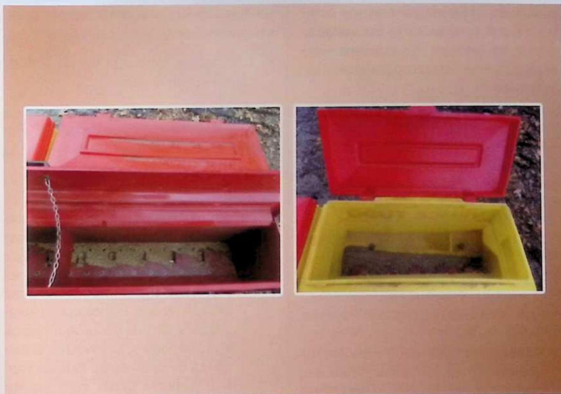
26-расм. Уруғлик учун металл қути ва минерал ўғит учун пластик қути.
