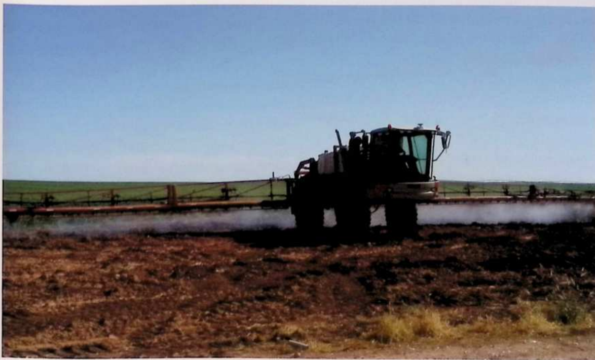
15-расм. Гербицидларни қўллаш учун қанотли пуркагич.
