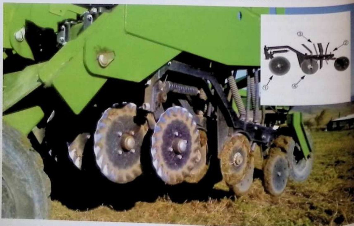
22-расм. Great Plains 1007NT шудгор қилмай экиш сеялкаси: 1 – қирқувчи диск (кольтер), 2 – уруғни экиш чуқурлигини назорат қилиш механизми, 3 – дискни тозалаш механизми, 4 – дискли сошник.
