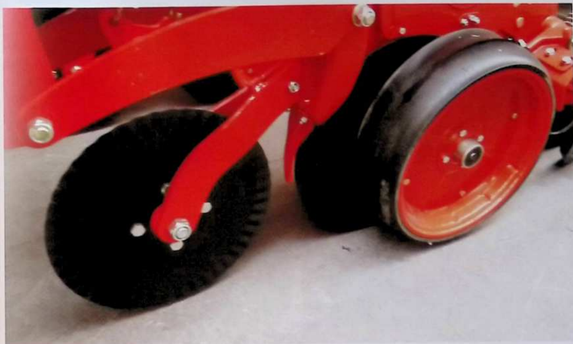
30-расм. Ўсимлик қолдиқларини қирқиш диски (кольтер).
