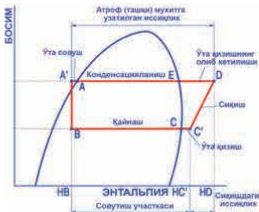
7-расм. Совитиш назарий циклининг энтуальпия (иссиқлик сақлами)-босим диаграммасидаги тасвири
