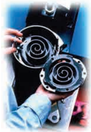
16-расм. Спираль компрессорнинг ишлаш принципи.
