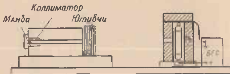
194- расм. \gamma - нурининг ютилиш коэффициентини аниқлаш учун қўлланиладиган қурилма.
