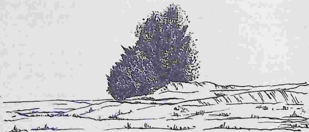
Рис. 38. Экспериментальный взрыв при взрывном выполаживании откосов отвала в Степной экспедиции ПО «Уралкварцсамоцветы»
